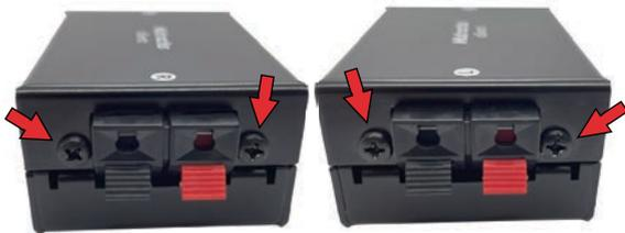
・ミュートラックス子機（以下、子機）側面にあるネジを 4 本はずしてください。
